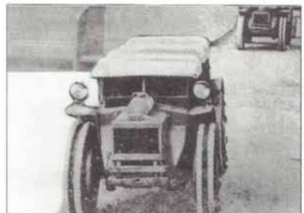
Αριστερά: ελκυστήρας πυροβολικού FIAT-PAVESI P4/110 4X4 που σύρει πεδινό πυροβόλο 105/25 κατά τη διάρκεια παρέλασης στην Αθήνα. Παρατηρήστε το τρίχρωμο καμουφλάζ. Δεξιά: ελκυστήρας πυροβολικού FIAT-PAVESI P4/100. Η διαμόρφωση που εικονίζεται είναι πολύ πιθανό να χρησιμοποιείτο ως "Άμαξα Αναγνώρισης Πυροβολικού"
