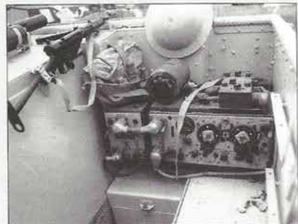
Wireless Set No 19 τοποθετημένο σε Bren Carrier
