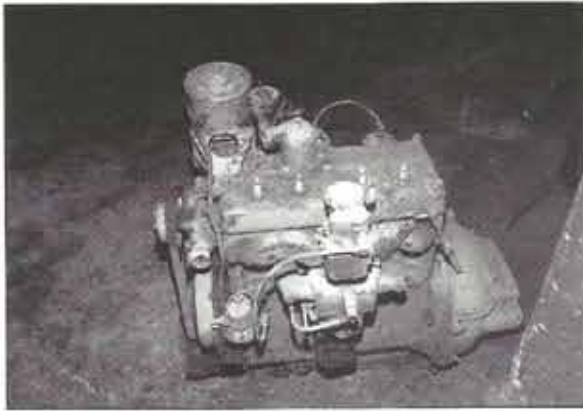
Νέος κινητήρας ανακατασκευασμένος σε Στρατιωτικό Συνεργείο (301 E.V.). Λειτουργεί άγρια μέχρι σήμερα από το 1980
