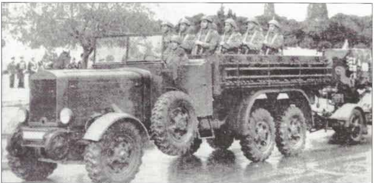
Φορητό Mercedes 6X6 LG 68 100PS ή αλλιώς LG 4000 επειδή ήταν 4 τόννων. Το φορητό σύρει κατευθυντήρα Α/Α πυροβολικού. Παρατηρήστε το τρίχρωμο καμουφλάζ παρόμοιο με αυτό του γερμανικού στρατού της εποχής.
