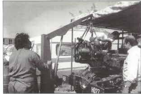
Τοποθέτηση νέου κινητήρα σε όχημα 1 1/2 τόννου DODGE WC62 6X6
